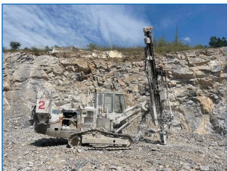
รูปที่ 2-22: การติดตั้งเครื่องดูดฝุ่นหัวเจาะ
